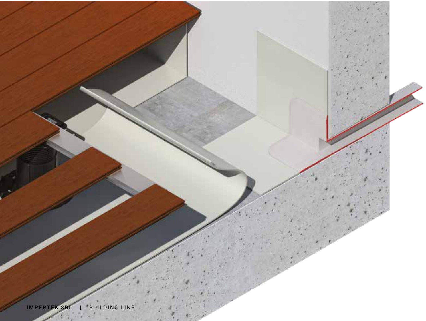
ESEMPIO DI POSA DI BOCCHETTA MIGNON REGULAR IN PVC CON TELI SINTETICI INSTALLATION EXAMPLES OF PVC MIGNON REGULAR CORNER FITTING WITH SYNTHETIC SHEETS
