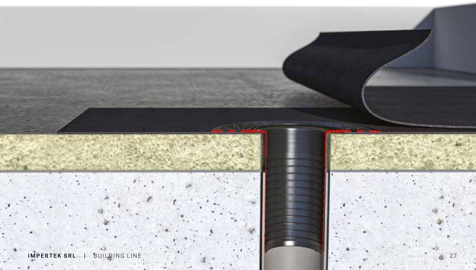
ESEMPIO DI POSA DI BOCCHETTA SLANG IN EPDM CON MANTI BITUMINOSI INSTALLATION EXAMPLES OF EPDM SLANG DRAIN CONNECTOR WITH BITUMINOUS MEMBRANES
