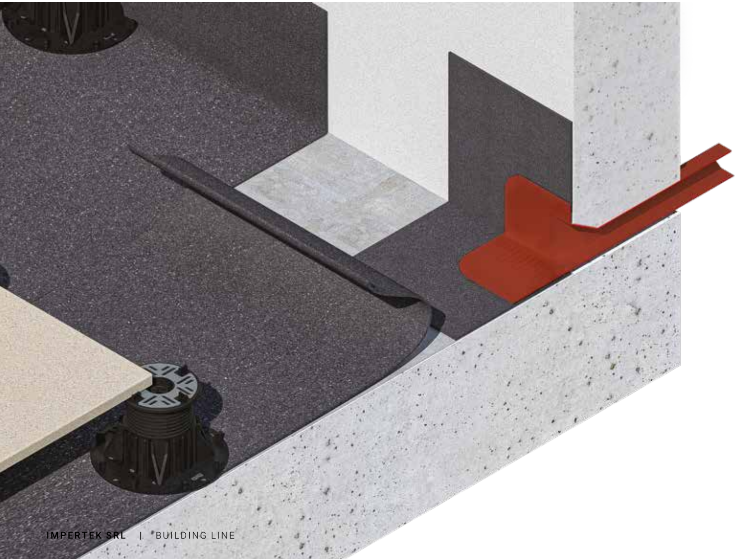
ESEMPIO DI POSA DI BOCCHETTA ANGOLARE MIGNON IN TPE CON MANTI BITUMINOSI INSTALLATION EXAMPLES OF TPE MIGNON CORNER FITTING WITH BITUMINOUS MEMBRANES
